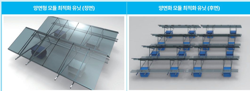
[그림 19. 양면형 모듈 최적화 수상태양광 유닛]
