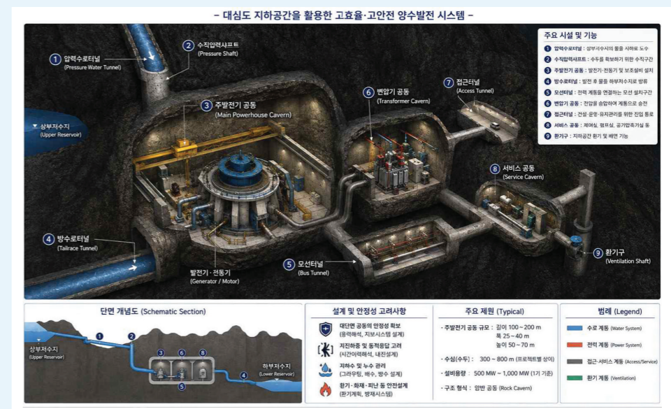
[그림 3] 양수발전소 단면 및 지하발전소 공동 개념도 (AI 생성)
