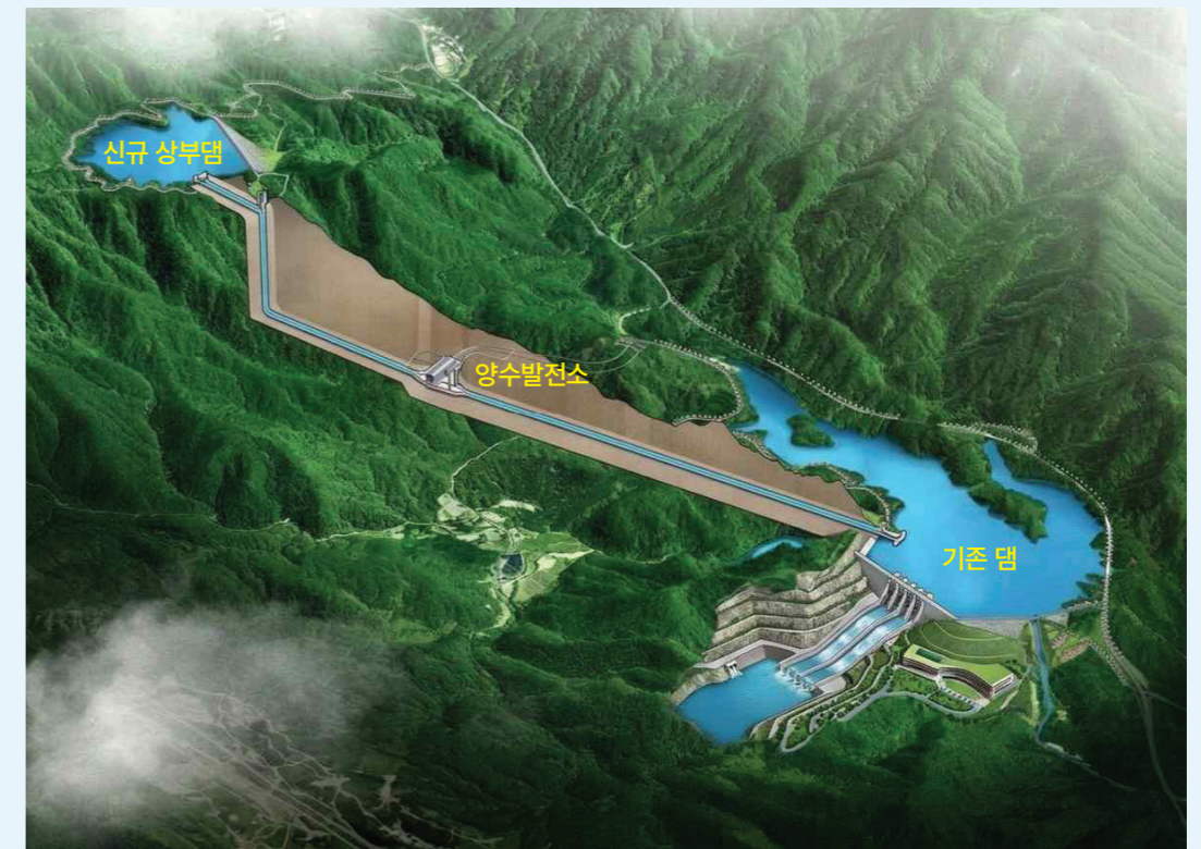
[그림 6] 기존 댐 활용형 양수발전 모식도
