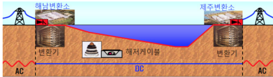
[그림 9] 해남-제주 간 HVDC 송전선로 개념도
