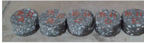
〈그림 9〉 다짐 아스팔트 콘크리트 코어층에서 채취한 실내시험용 시편 (Tschernutter 2015)
