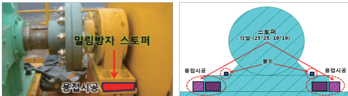
〈그림 29〉 당초 플랜지형 커플링(좌) 및 개선 일체형 구조(우)
