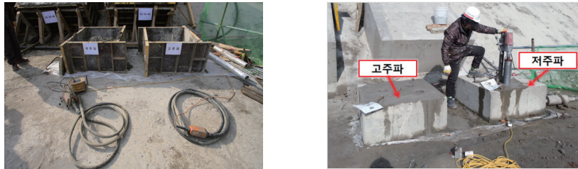
〈그림 21〉 고주파, 저주파 다짐기 비교시험(좌) 및 코어 채취 전경(우)
