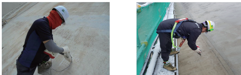
〈그림 22〉 콘크리트 강도 시험 전경
