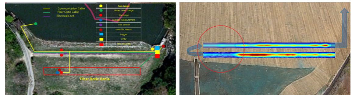
노후 저수지 센서 설치, 누수 Spot 탐지
